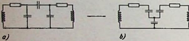
Bild 7. Kapazitive Kopplung; a = Dreieck, b = Stern
